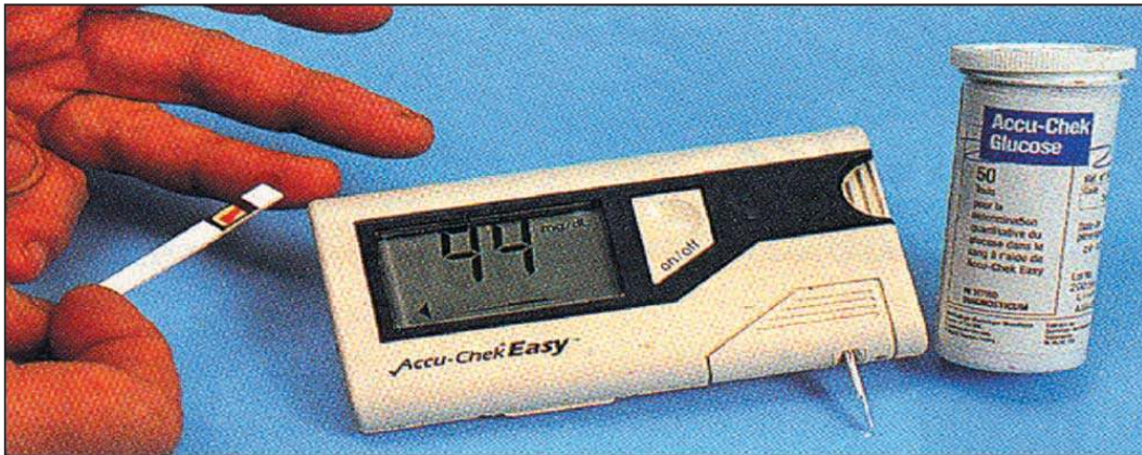
1. Glucomètre : appareil pour la mesure de la glycémie
