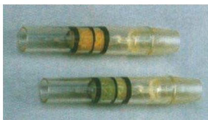
Figure 10b. Dans le tube le réactif initialement jaune orangé vire au vert en présence d'alcool
