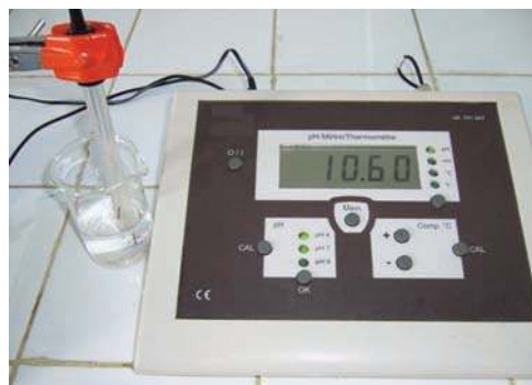
Figure 5. Mesure du pH d'une solution aqueuse d'ammoniac
