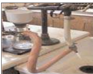
Figure 3. Filtration avec un dispositif Büchner.
