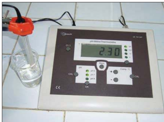
Figure 2. pH d'une solution de chlorure d'hydrogène 5.10^{-3} M.
