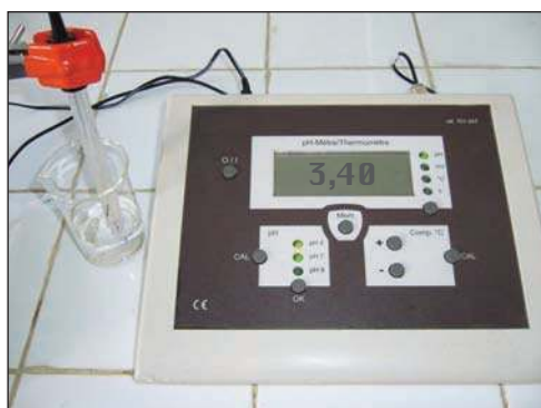
Figure 4. Mesure du pH de la solution d'acide éthanoïque 10^{-2} M.
