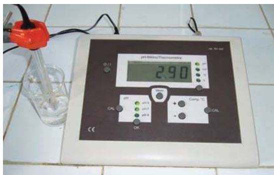
Figure 3. Mesure du pH d'une solution aqueuse d'acide méthanoïque.
