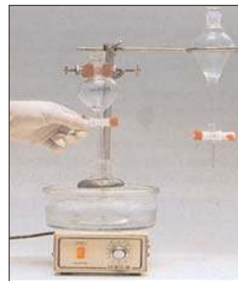
Figure 2. Obtention de l'éthanoate de butyle.
