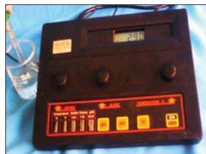
Figure 4. Mesure du pH d'une solution d'acide éthanóique.
