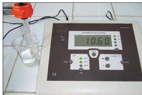
Figure 5. Mesure du pH d'une solution aqueuse d'ammoniac.
