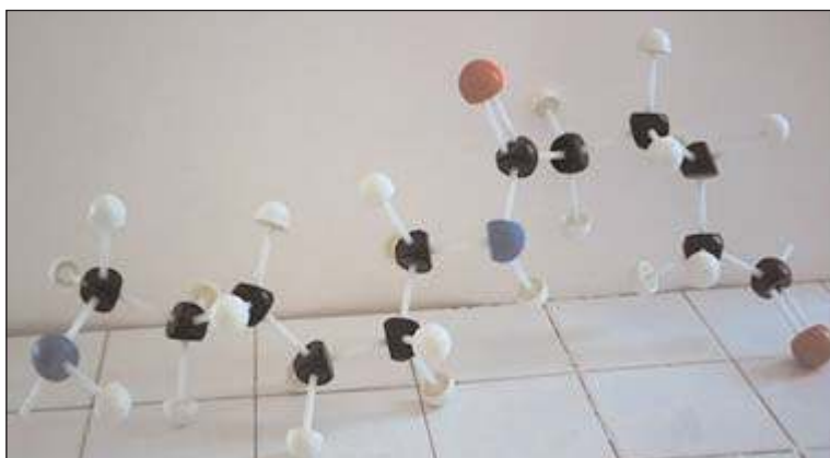
Figure 3. Modèle éclaté d'un motif du polyamide nylon 6,6.
