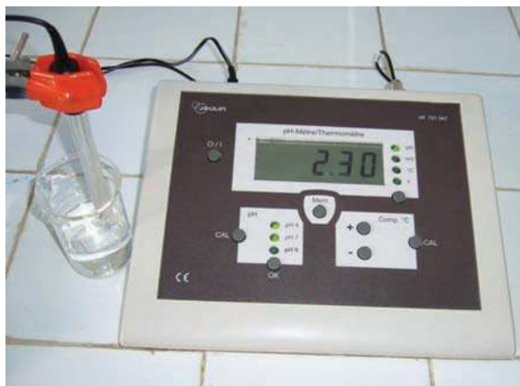
Figure 2. pH d'une solution de chlorure d'hydrogène 5.10^{-3} M.
