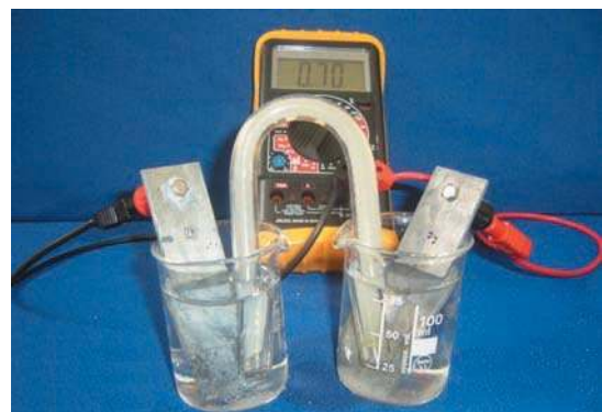
b) Mesure de la f.é.m. de la pile ( P_a ) après dilution
