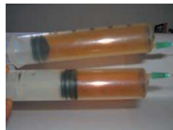
Figure 2. Mise en évidence de l'effet de la variation de la pression à température constante sur un système fermé initialement en équilibre dynamique.
