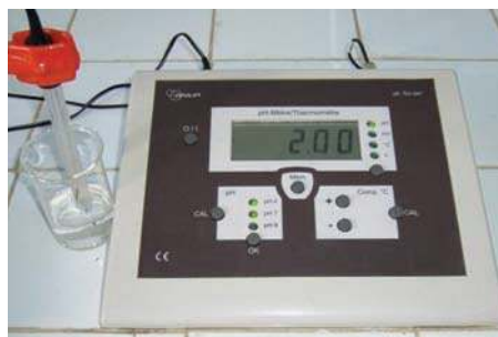
Figure1. Mesure du pH d'une solution aqueuse de chlorure d'hydrogène
