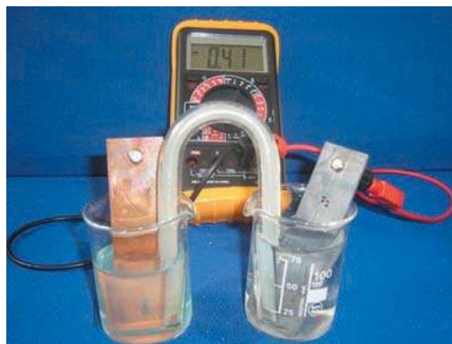
b) Mesure de la f.é.m. de la pile ( P_b ) après dilution
