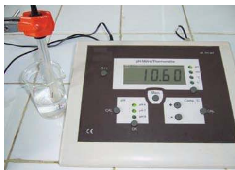
Figure 5. Mesure du pH d'une solution aqueuse d'ammoniac
