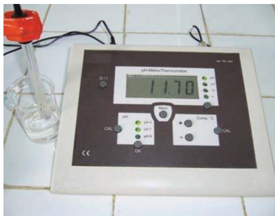
Figure 3. pH d'une solution d'hydroxyde de sodium 5.10^{-3} M.
