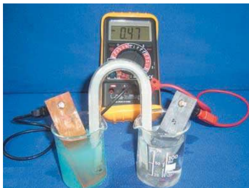
a) Mesure de la f.é.m. de la pile ( P_b ) avant dilution
