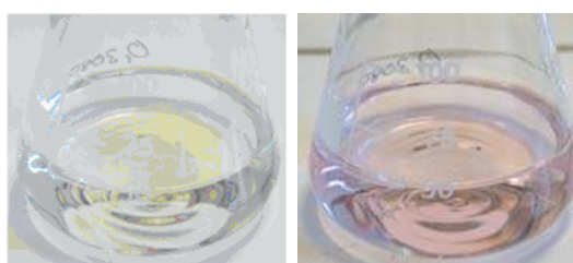
figure 7 : déroulement du dosage (a) avant l'équivalence; (b) à l'équivalence
