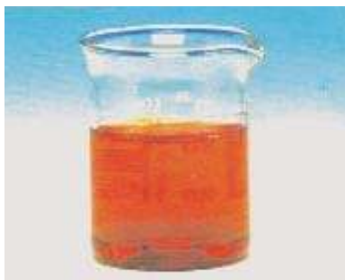
Schéma 5 : Réaction des ions iodure I^- avec le peroxyde de dihydrogène H_2O_2 .
