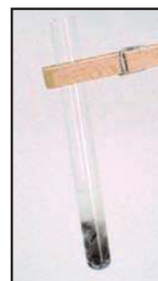
Figure 9. Réaction du plomb avec l'acide chlorhydrique
