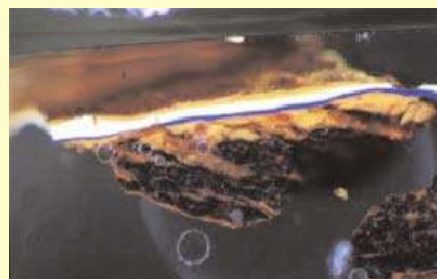
Coupe stratigraphique de peinture d'un système anticorrosion appliqué sur une surface mal nettoyée
