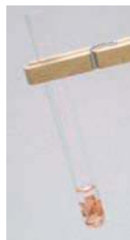
Figure 10. L'acide chlorhydrique ne réagit pas avec le cuivre
