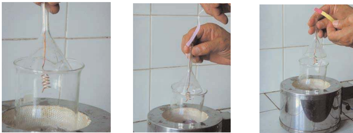
Figure 10. Réaction d'oxydation ménagée de l'éthanol par le dioxygène de l'air.
