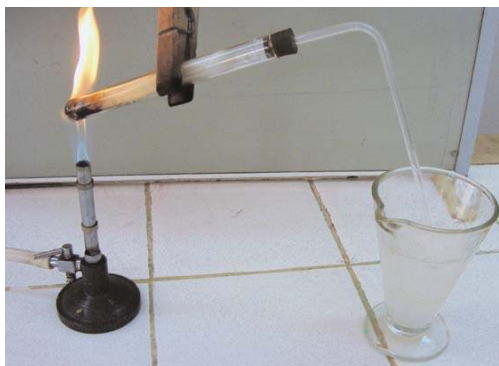
Figure 4 : Oxydation de l'amidon par l'oxyde de cuivre (II)
