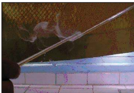
Figure 1 : Réaction du chlorure d'hydrogène \text{HCl} avec l'ammoniac \text{NH}_3
