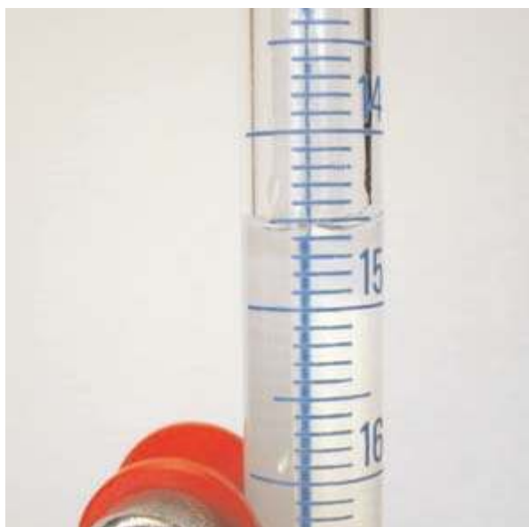
figure 5 : mesure du volume ajouté V_{BE} = 14,6 \text{ mL}
