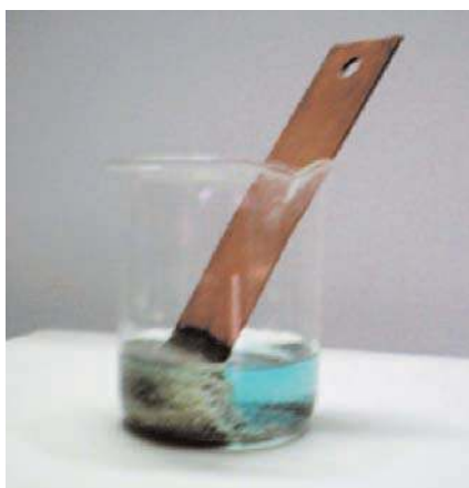
Figure 5 : Réaction du cuivre métallique avec les ions argent.
