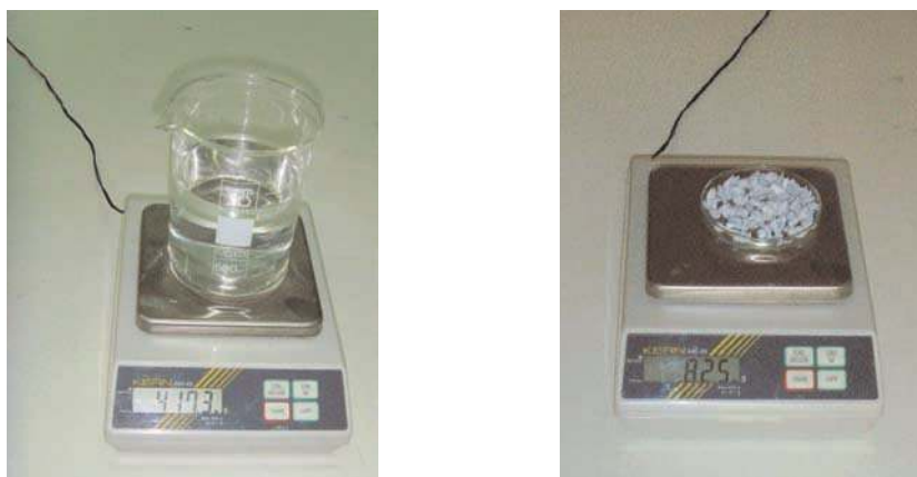
Figure 1. Détermination de la masse de deux échantillons d'eau et de zinc à l'aide d'une balance électronique.
