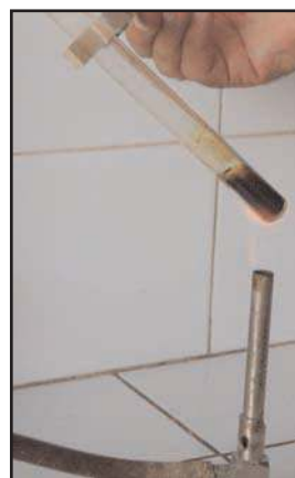
Figure 1. : Pyrolyse de la sciure de bois
