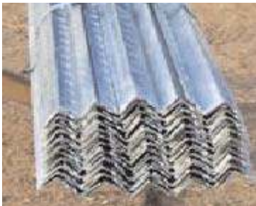
Des cornières galvanisées
