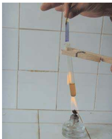
Figure 5. Réaction de l'urée avec la chaux sodée.
