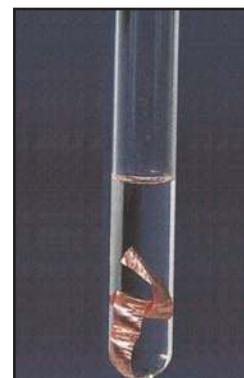
Figure 10. L'acide chlorhydrique ne réagit pas avec le cuivre
