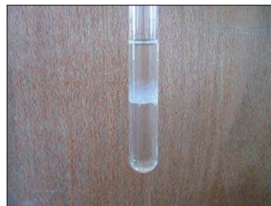
Avec \text{Al}^{3+} une solution aqueuse d'éthylamine donne un précipité blanc de \text{Al(OH)}_3
