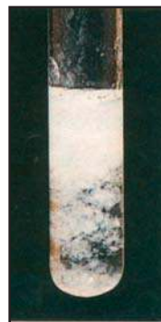
Figure. 5b. Mise en évidence des ions \text{Zn}^{2+}
