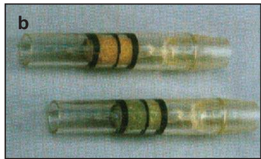
Figure 18 b. Dans le tube le réactif initialement jaune orangé vire au vert en présence d'alcool
