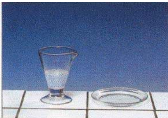
Figure 9 b. Test à l'eau de chaux
