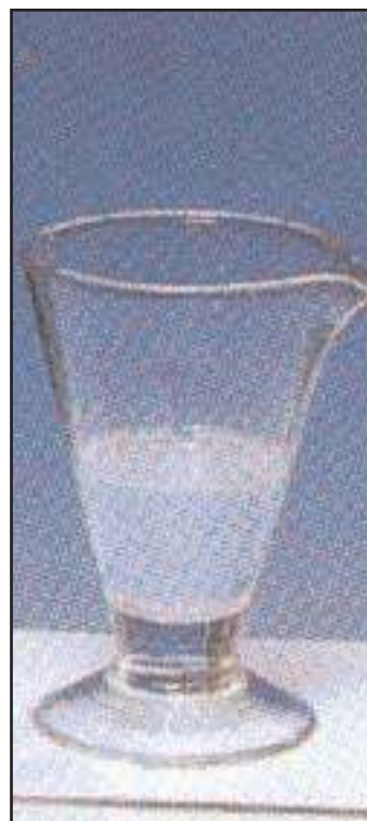
Figure 3b. Test à l'eau de chaux
