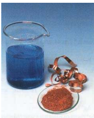
Figure 9 : Les deux formes du couple \text{Cu}^{2+}/\text{Cu} . Le cuivre Cu se présente en copeaux ou en poudre rouge. Les ions \text{Cu}^{2+} colorent en bleu une solution de sulfate de cuivre (II).
