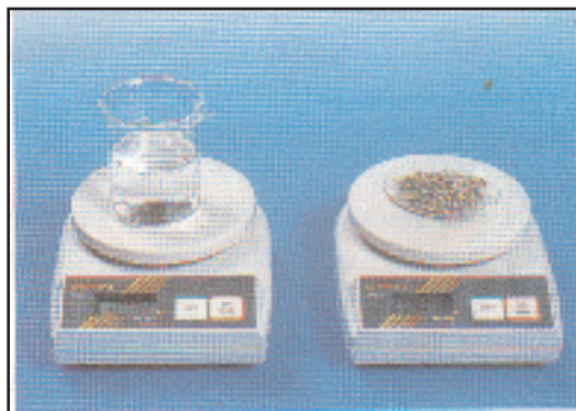
Figure 1. Détermination de la masse de deux échantillons d'eau et de plomb à l'aide d'une balance électronique.
