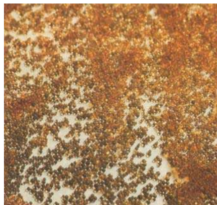
Figure 8 : Graines de résines échangeuses d'ions.
