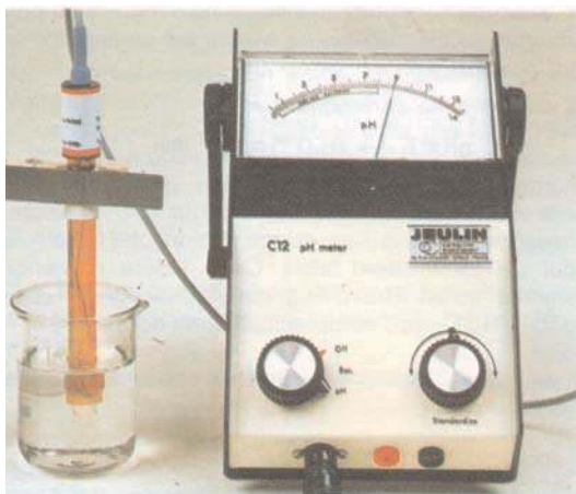
Mesure du pH à l'aide d'un pH-mètre à aiguille
