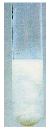
La formation d'un précipité blanc de chlorure d'argent révèle la présence d'ions \text{Cl}^- .
