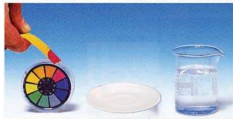
Détermination du pH à l'aide du papier pH : méthode à la touche
