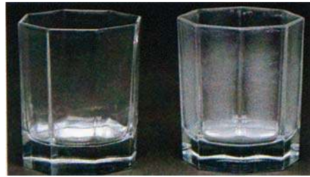
Au bout de quelques semaines de lavage par un détergent basique, l'attaque est perceptible sur le verre de droite, devenu terne.
