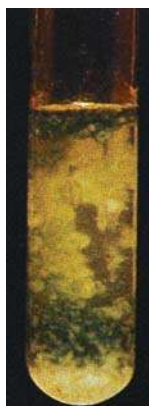
La formation d'un précipité vert d'hydroxyde de fer (II) révèle la présence d'ions \text{Fe}^{2+} .
