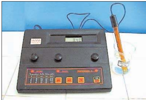
Mesure du pH de la solution ( S_2 ) d'acide éthanóique.
