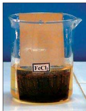
Lame de zinc plongée dans une solution de chlorure de fer (II) : après la réaction
