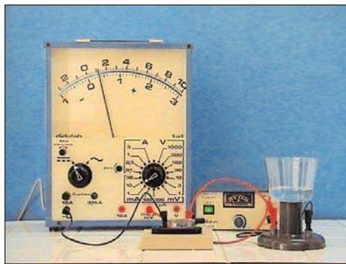
L'électrolyseur (2) contient la solution d'ammoniac
