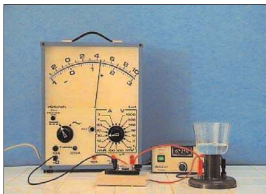
Figure a : électrolyseur contenant la solution ( S_1 ) de chlorure de sodium.
