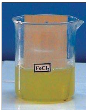
Lame de zinc plongée dans une solution de chlorure de fer (II) : avant la réaction
