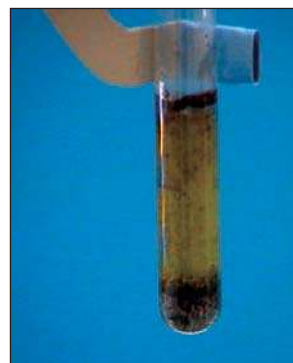
Action de l'acide chlorhydrique sur le fer
