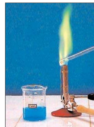
Couleur verte de la flamme caractéristique de l'ion \text{Cu}^{2+}
