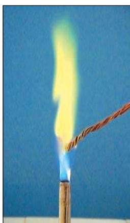
Présentation des fils de cuivre à la flamme d'un bec bunsen
