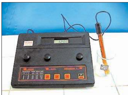
Mesure du pH de la solution (S 1 ) d'hydroxyde de sodium.
