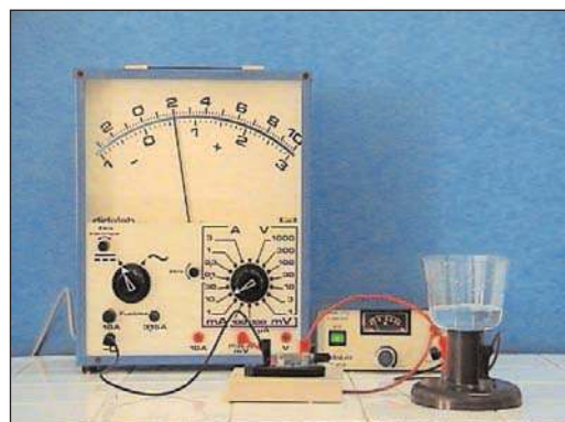
Figure b : électrolyseur contenant la solution ( S_2 ) d'acide éthanóique.
