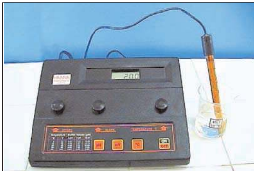
Mesure du pH de la solution ( S_1 ) de chlorure d'hydrogène.
