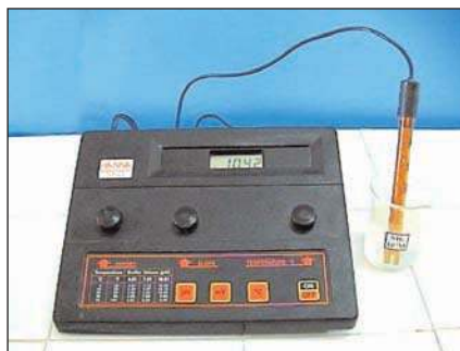
Mesure du pH de la solution (S 2 ) d'ammoniac.
