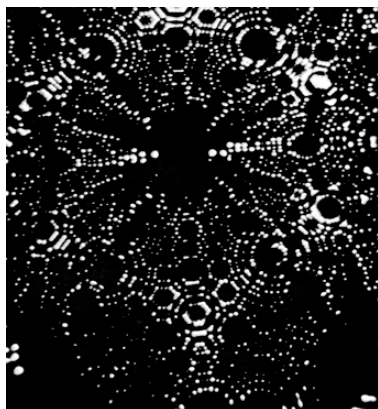
Fig 2: Image agrandie quatre millions de fois, d'une pointe de tungstène vue au microscope à champ ionique
