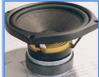
Fig.9 : Haut-parleur est un transducteur de base en communication
