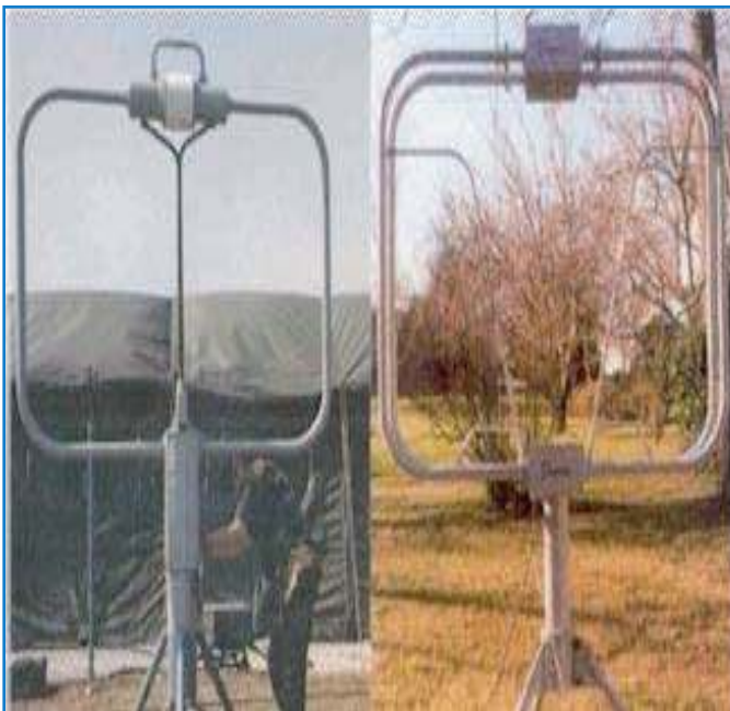
Fig.22 : Antennes comportant une bobine transformant l'énergie magnétique en un signal électrique, utilisée par les militaires
