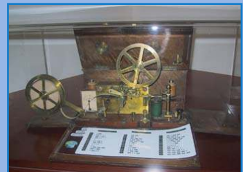
Fig.1 : Télégraphe électrique de Morse(1837)
