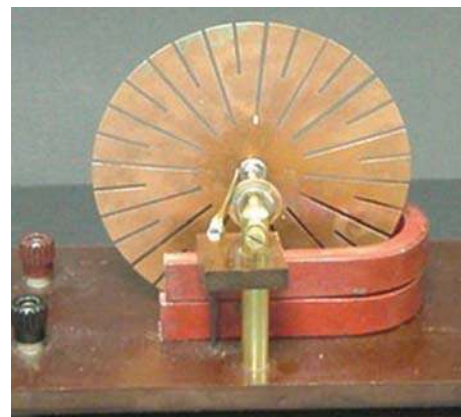
La roue de Barlow est l'ancêtre des moteurs électriques.
