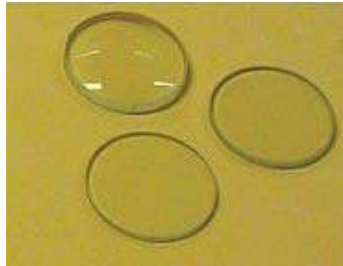
Photo.1-b : Lentilles à bords minces LENTILLES CONVERGENTES
