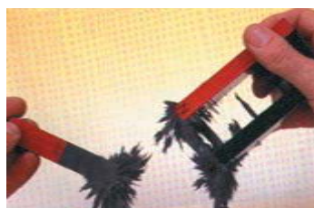
Photo.3 : limaille de fer attirée par les deux pôles d'un aimant en U et d'un barreau aimanté.
