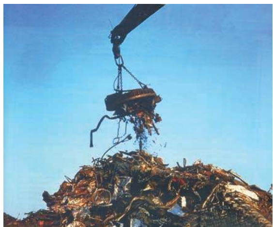
Photo.1-b : Grue munie d'un conducteur parcouru par un courant électrique, crée un champ magnétique capable d'attirer certains métaux à la manière d'un aimant
