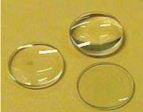
Photo.1-a : Lentilles à bords épais LENTILLES DIVERGENTES
