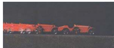
Photo.3 : chronophotographie d'un corps en mouvement rectiligne uniformément accéléré.
