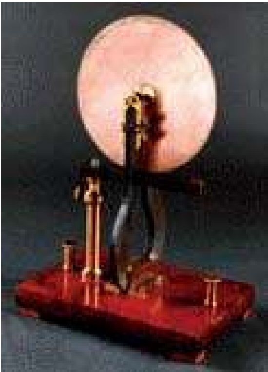
Photo.1-a : la roue de Barlow est l'ancêtre des moteurs électriques.
