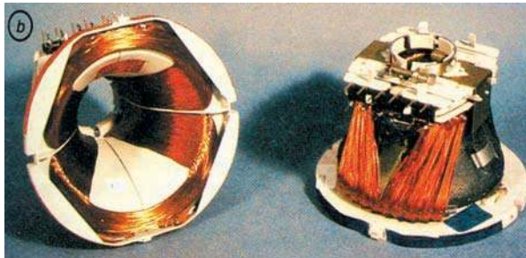
Photo.7-b : Bobines de déflexions magnétiques du tube cathodique d'un téléviseur
