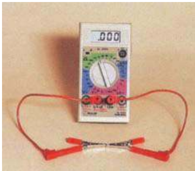
Figure 1. Mise en service et contrôle du fonctionnement de l'ohmmètre
