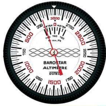
La mesure de la pression atmosphérique donne une indication sur l'altitude à laquelle on se trouve : un baromètre peut être utilisé en altimètre.
