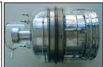
Fig. 20 Transformateur élévateur de tension
