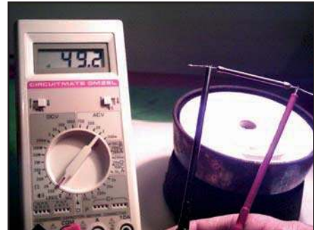
Fig.13 b ▶ On lit R = 49,2 \Omega quand le fil est chauffé
