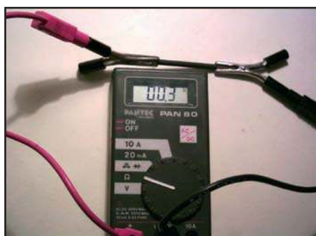
Fig.14 a A froid, l'électrode de graphite a une résistance de 0,3 \Omega
