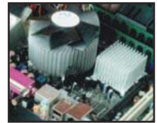
Fig.14- Radiateurs en aluminium et ventilateur miniature sur les processeurs d'un PC
