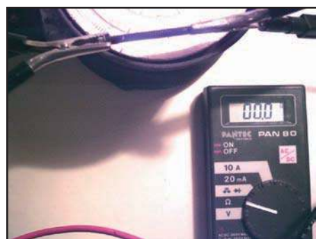
Fig.14 b A chaud, sa résistance descend au dessous de 0,1 \Omega (on lit 00,0)
